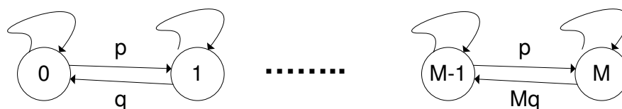
Σχήμα 3: Μαρκοβιανή αλυσίδα M καταστάσεων.
